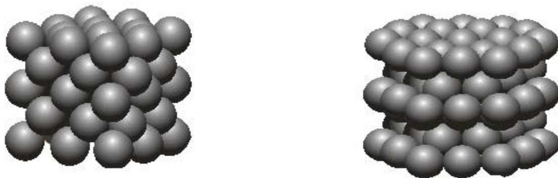
*Рис.1.3. Схематическое изображение синтетического опала, сформированного в виде гранецентрированной кубической решетки (слева) и в виде гексагональной плотноупакованной решетки (справа).*
