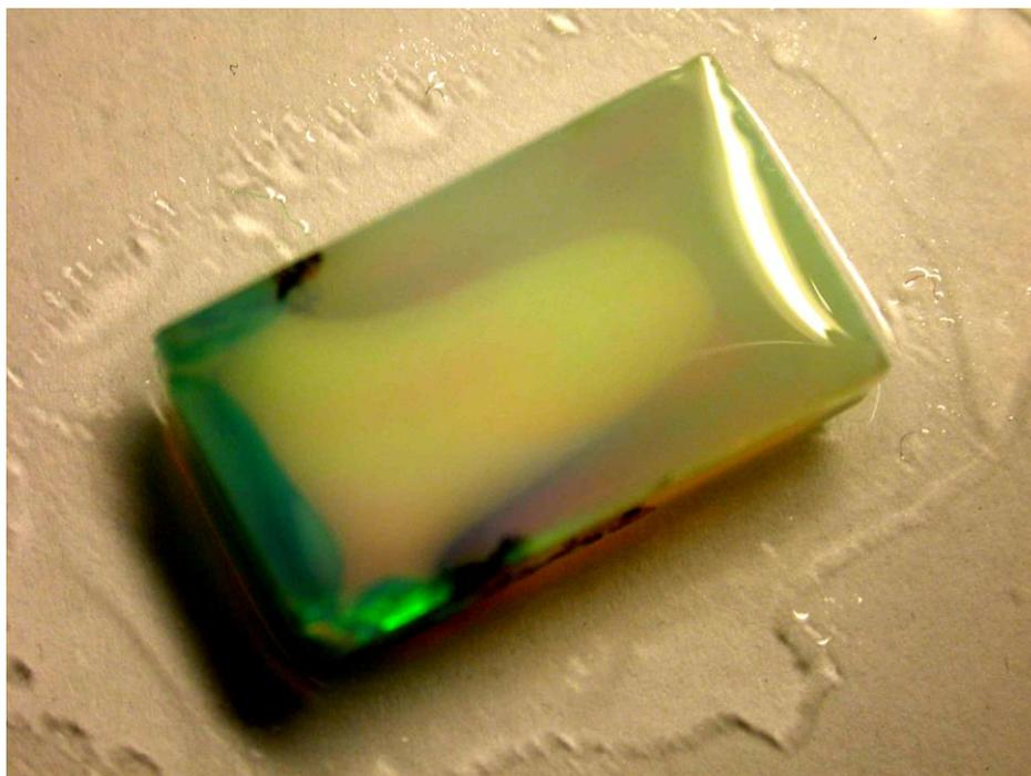
*Рис.1.7. Фотография образца синтетического опала, инфильтрованного водой.*
