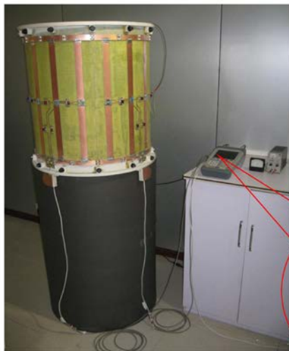
Автономные испытания передающей катушки
