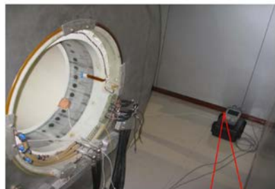
Испытания передающей катушки в магните
