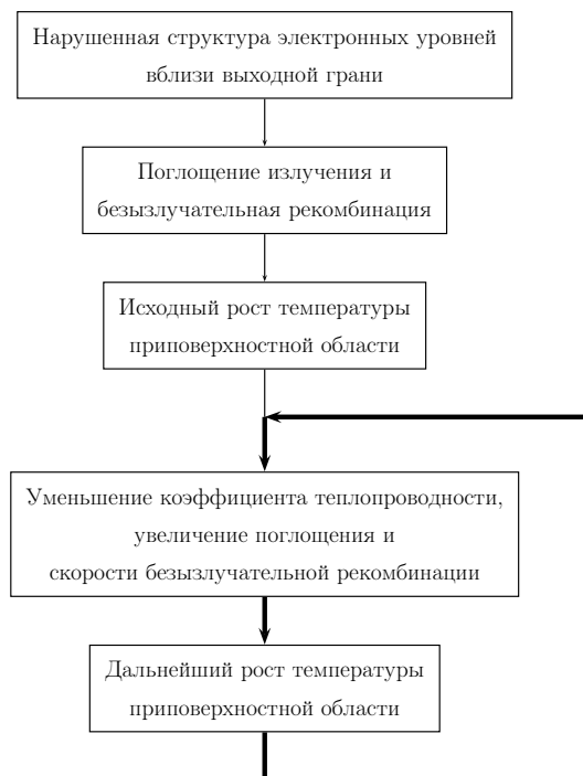
Рис. 1: Возникновение положительной обратной связи, приводящей к КОД
