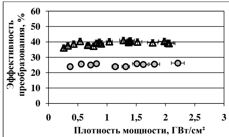
Рисунок 5. Зависимость эффективности преобразования деполяризованного излучения во вторую гармонику от плотности мощности излучения на кристалле KDP длиной 30 мм: \circ – \theta = 3.5 мрад, N = 1000 шт; \Delta – \theta = 1.2 мрад, N = 100 шт.
