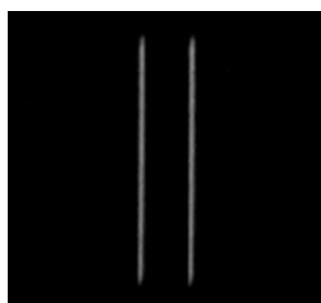
Рисунок 3.1.22. Дуплет линий излучения ртутной лампы в четвёртом порядке дифракции.
