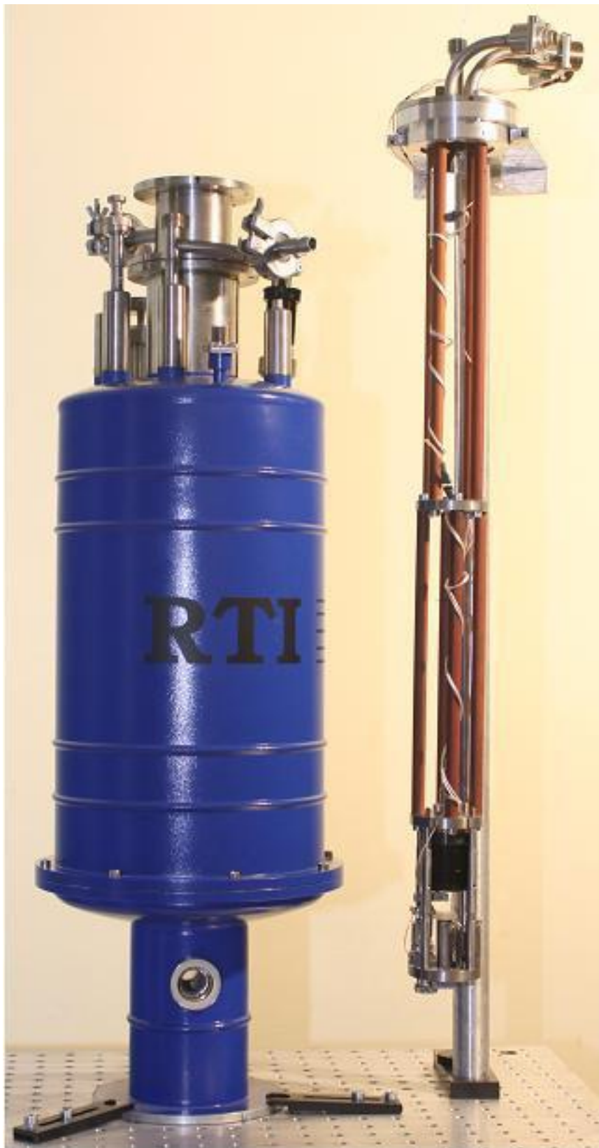
Рис. 20. Фотография оптического гелиевого криостата и вставки с головкой СБОМ.
