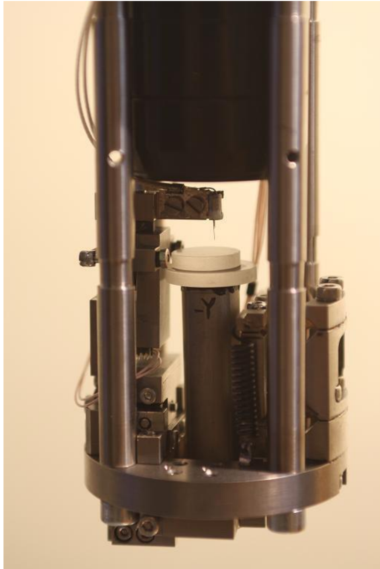
Рис. 21. Головка СБОМ, смонтированная на вставке в оптический гелиевый криостат.
