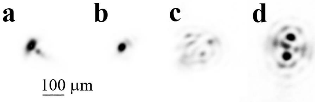
Рис. 45 Поперечные профили распределения интенсивности лазерного пучка в дальней зоне: а – исходный (неисправленный) импульс, б – исправленный адаптивным зеркалом, в – aberrацией одного знака, д – другого знака.
