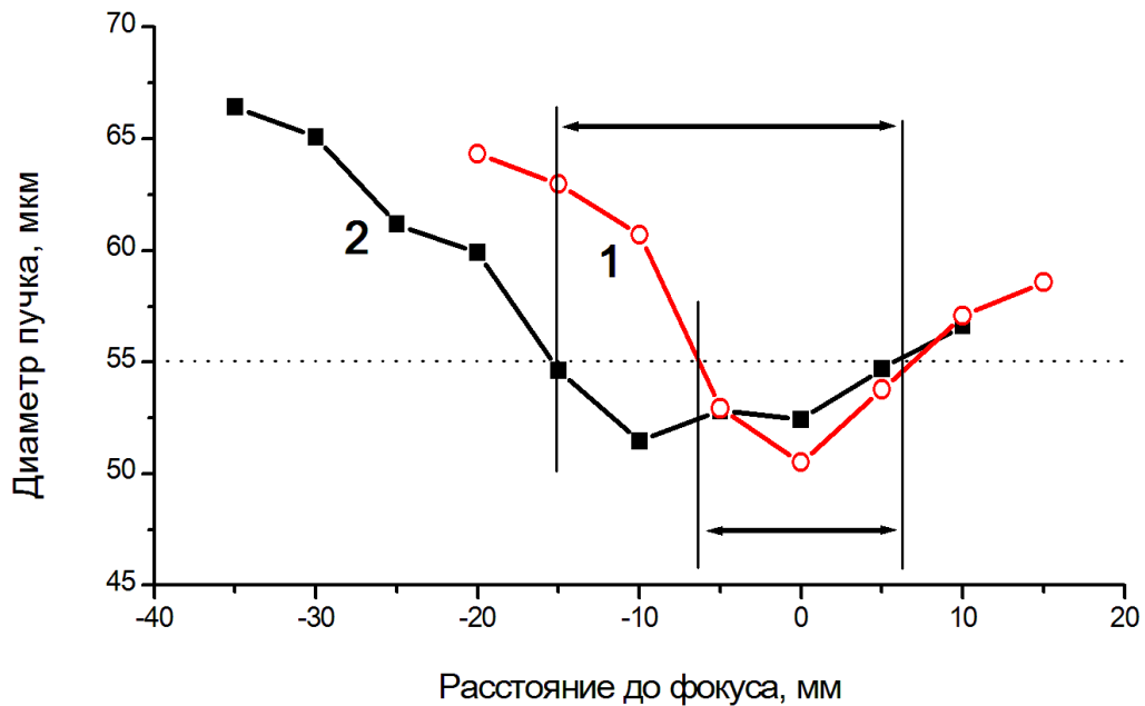
Рис. 47. Зависимость диаметра пучка с длиной волны 248 нм от расстояния до линейного фокуса (0 мм). Горизонтальной пунктирной линией обозначен уровень 55 мкм, вертикальными линиями обозначены области филаментации излучения без (1) и с (2) внесением aberrаций.
