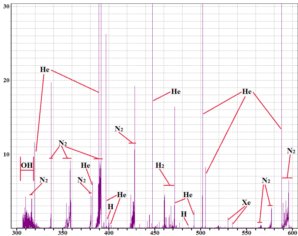
Рис. 3.2.4. Спектр для разряда в смеси He:H 2 O:Xe=33:20:1 в области 300-600 нм.
