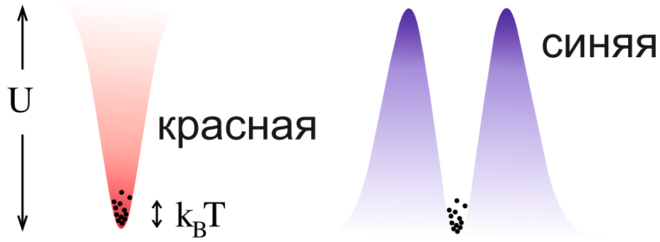
Рисунок 3.1 — Вид потенциала для «красной» (слева) и «синей» (справа) дипольных ловушек. Атомы обозначены точками, средняя кинетическая энергия атомов E_k = k_B T . В «красной» ловушке атомы находятся в области максимальной интенсивности излучения в потенциальной яме, в то время как в «синей» ловушке в области минимальной интенсивности между потенциальными холмами.
