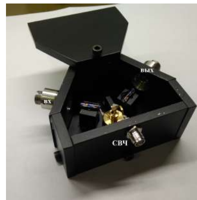
Рисунок 3.9 — Схема эксперимента. ИЗ – изолятор; КП – контроллер поляризации; ВХ – волоконный вход; ВЫХ – волоконный выход; К1,К2 – коллиматоры; Л1,Л2 – асферические линзы; П – призма; Дет. – высокочастотный детектор; ЭП – элемент Пельтье; ПТ – плата для активной стабилизации. Фотография коробочки ЭОМ модулятора размерами 150 \times 100 \times 80 мм, диапазоном модуляции [200:900] МГц и V_{\pi} = 0.5 В.
