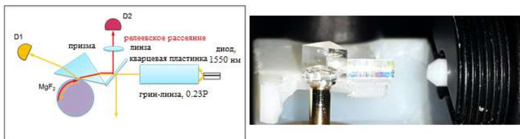
Рисунок 5.8 — Слева: схема измерений резонансного рэлеевского рассеяния при связи полупроводникового лазерного диода с микрорезонатором через призму; справа: фотография компактного расположения микрорезонатора, призмы и фокусирующей градиентной линзы в эксперименте.
