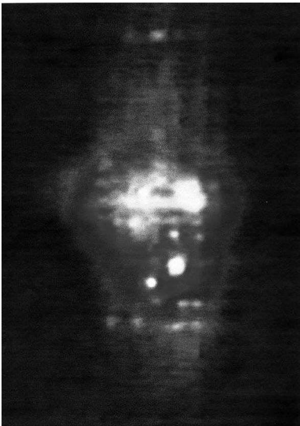
Рис.1.12. Фотография экрана, расположенного на расстоянии 5 м от геометрического фокуса (Schillinger H. and Sauerbrey R., 1999). Яркие пятна соответствуют излучению суперконтинуума, генерируемого в отдельных филаментах.
