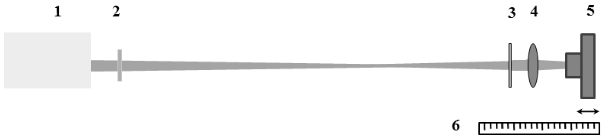
Рис. 4.25. Оптическая схема экспериментов: 1 – титан-сапфировая лазерная система, 2 – кварцевая пластинка, 3 – экран, 4 – линза, 5 – перемещаемая ПЗС камера, 6 – линейка
