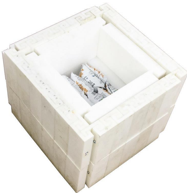
Рисунок 3.2 Стенд для получения гамма-линий методом нейтронной активации (нейтронный стенд). Внутри стенда видны пакеты с карбонидом, служившим источником азота, под ними распложены лист железа и полиэтиленовая сборка с нейтронным источником.
