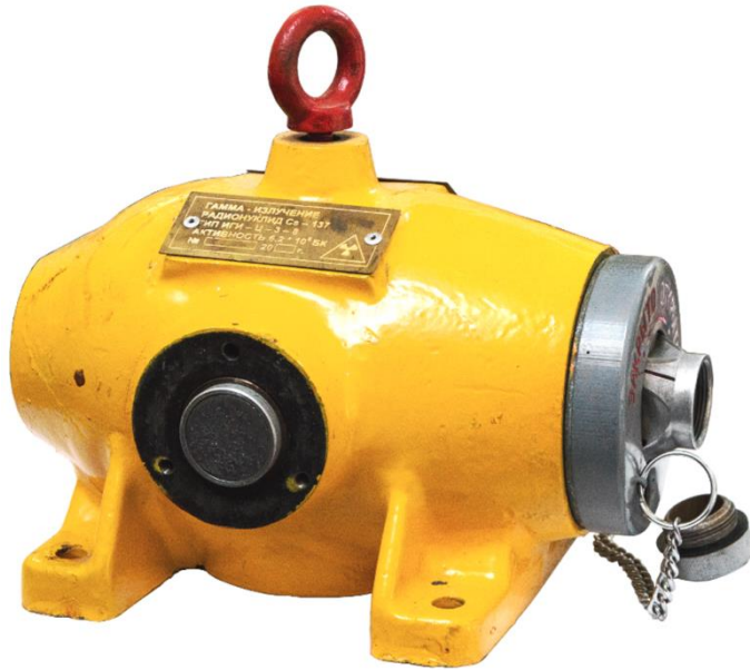
Рисунок 3.18 Блок гамма-источников БГИ 45А IP54 с закрытым коллимационным каналом
