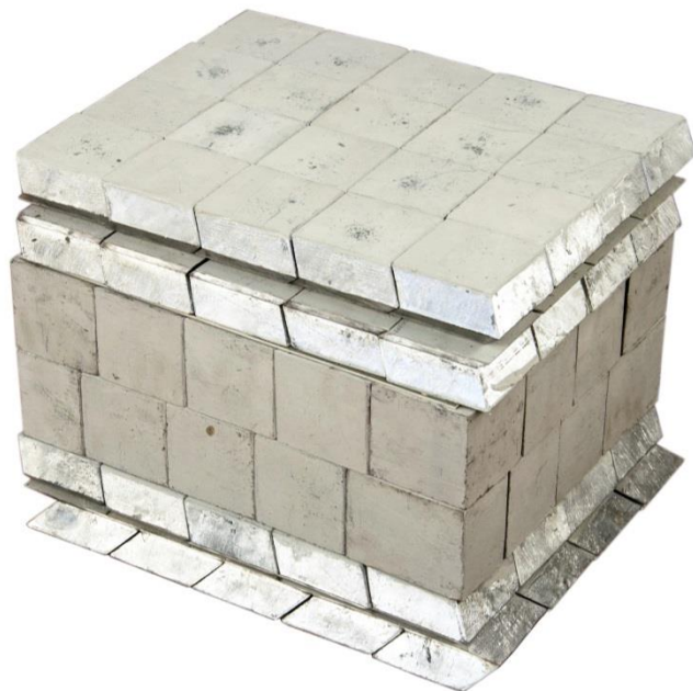
Рисунок 3.21 Низкофоновая свинцовая камера
