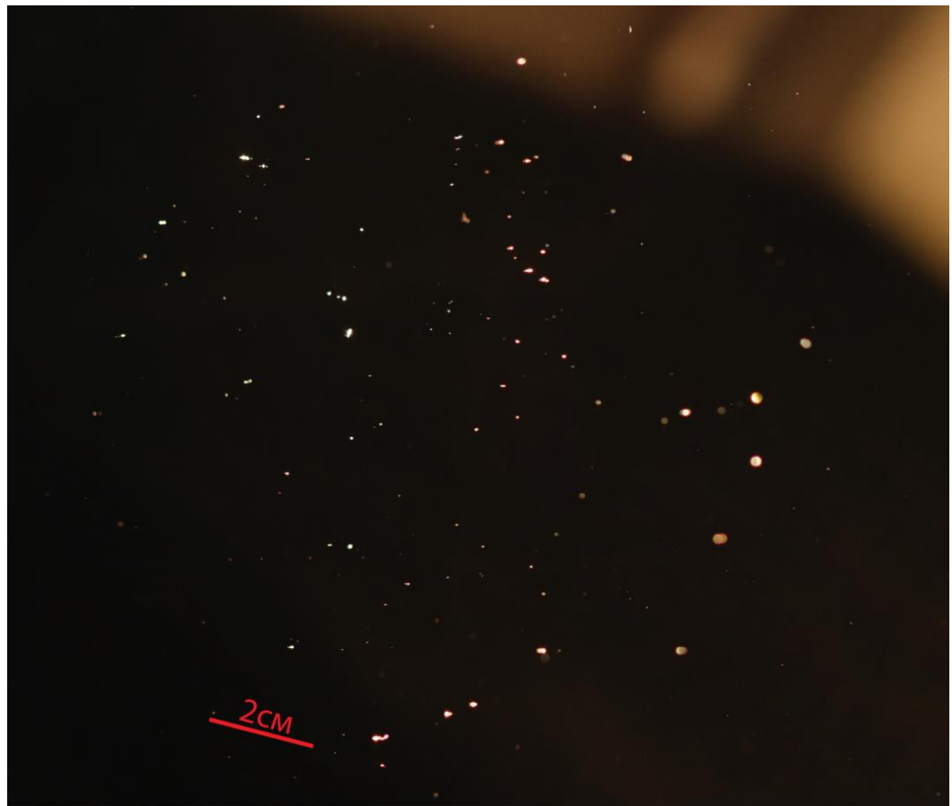
Рис. 4.18 Дефекты в выходном окне усилителя Бердыш, образовавшиеся в результате оптического пробоя в филаментах.
