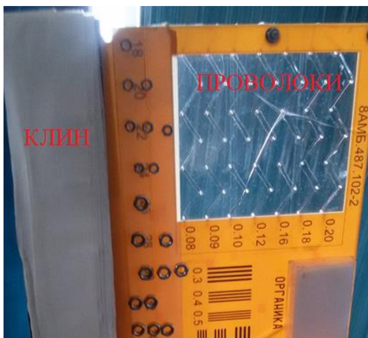
Рисунок 1.9. Фотография фантом, используемого ООО «СКБ Медрентех» для тестирования УПДЧ «Хомоскан».
