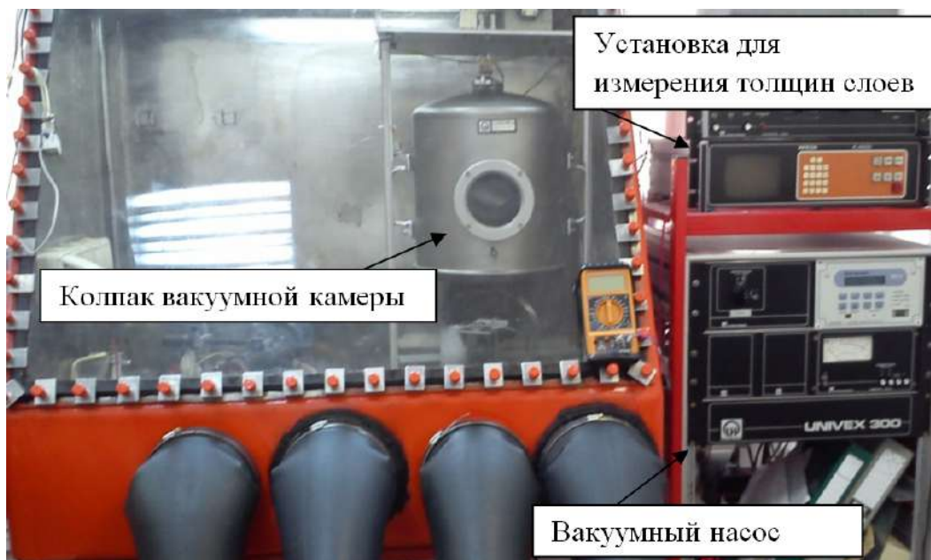
Рис. 2.9. Установка для термического напыления.
