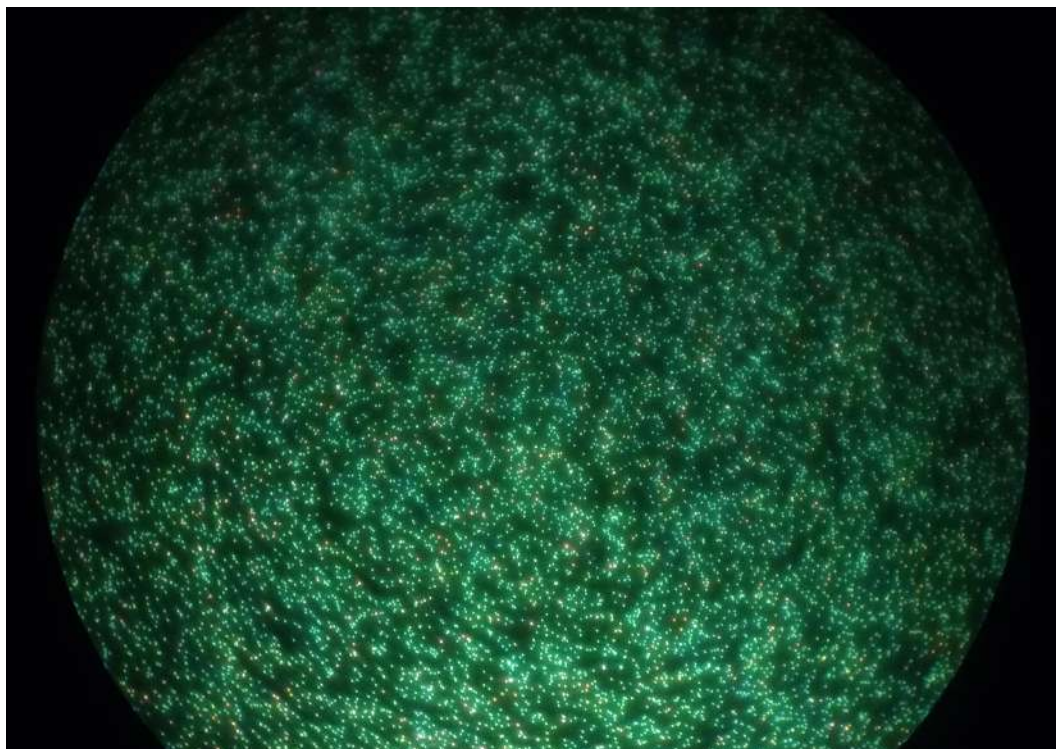
Рис. 2.4. Изображение нанокубиков в темном поле. Диаметр поля зрения составляет 500 мкм.
