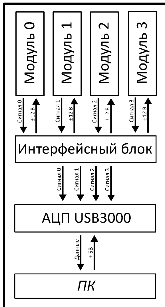
Рис. 4.1 – Блок схема аппаратно-программного комплекса «Гамма-спектрометр» в CASLEO.
