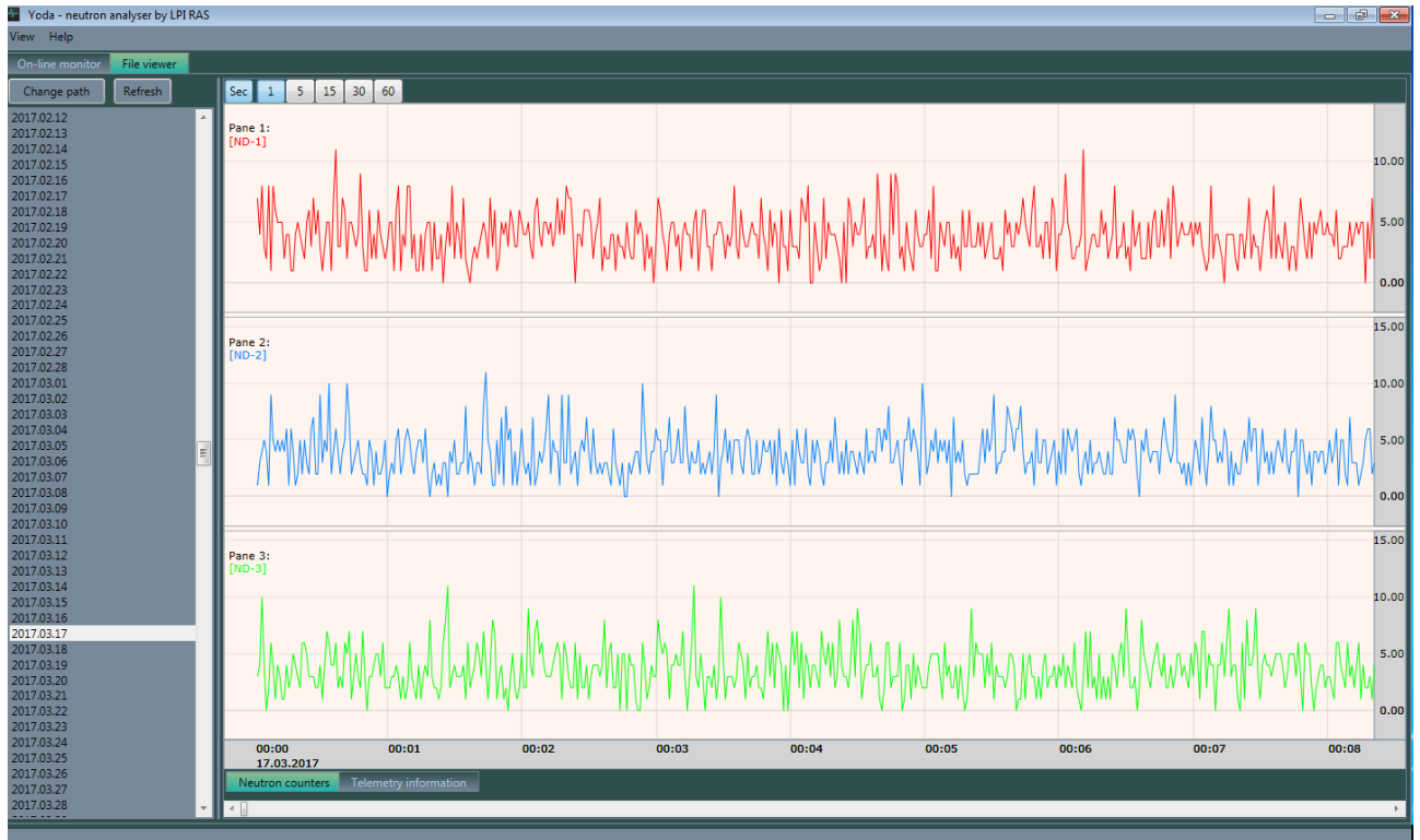
Рис.3.8 – Главное окно программы «Yoda terminal». Разными цветами показаны графики вариаций темпа счёта нейтронов по каждому из 3-х модулей НД CASLEO.
