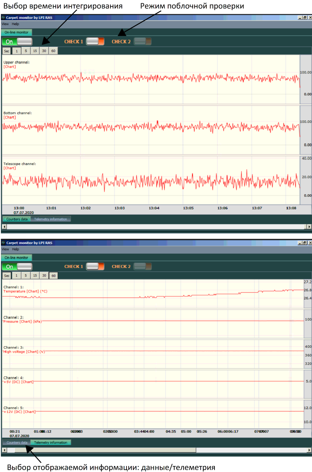
Рис. 2.8 – Интерфейс программы CARPET Monitor: верхняя панель – режим отображения данных, нижняя панель – режим отображения телеметрии.
