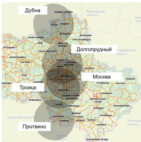
Рис. 19. Проекция областей, генерирующих мюоны на высоте 16 км в интервале зенитных углов 0^\circ - 70^\circ , на карте Подмосковья.
