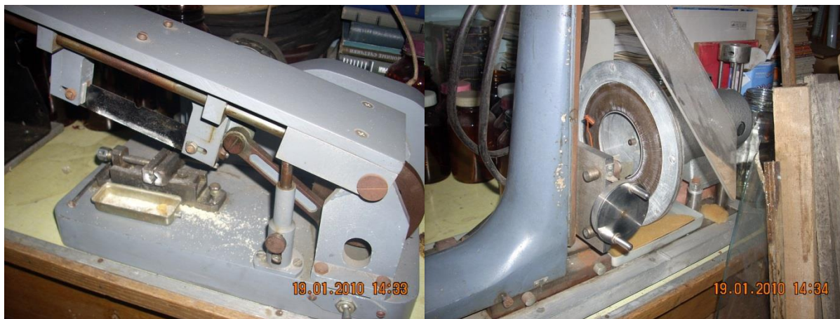
Рис. 41. Прецизионные станки, используемые для среза и шлифовки кристаллов оливина.
