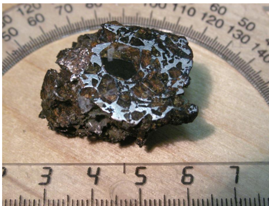
Рис. 33. Образец метеорита Eagle Station, сфотографированный на фоне транспортира, используемый для исследований в эксперименте ОЛИМПИА.
