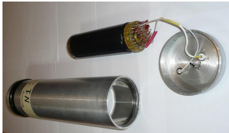
Рис. 2.8. Внешний вид детектора с извлеченным из корпуса фотоумножителем ФЭУ-30.
